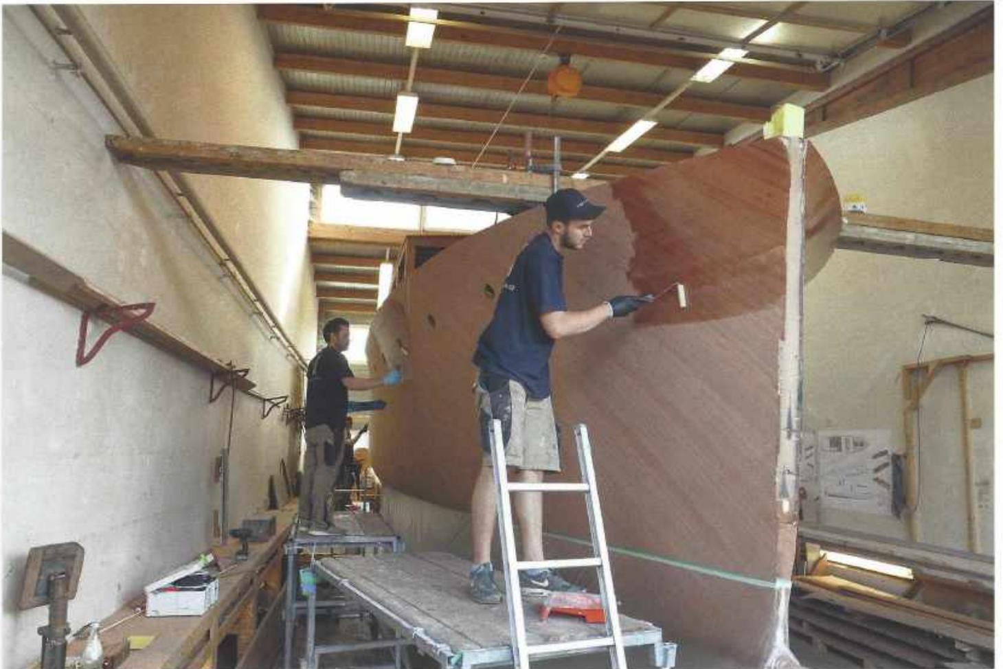
Links oben und unten: Nach dem doppelten Überfurnieren des abgedichteten Rumpfes wird mit den Lack-Arbeiten begonnen. Rechts: bevor neue Holzteile eingepasst werden konnten, musste viel morsches Altholz entfernt werden – eine mühsame und mitunter auch körperlich sehr anspruchsvolle Aufgabe, welche die Mitarbeiter der Heinrichwerft jedoch mit Bravour meisterten.
